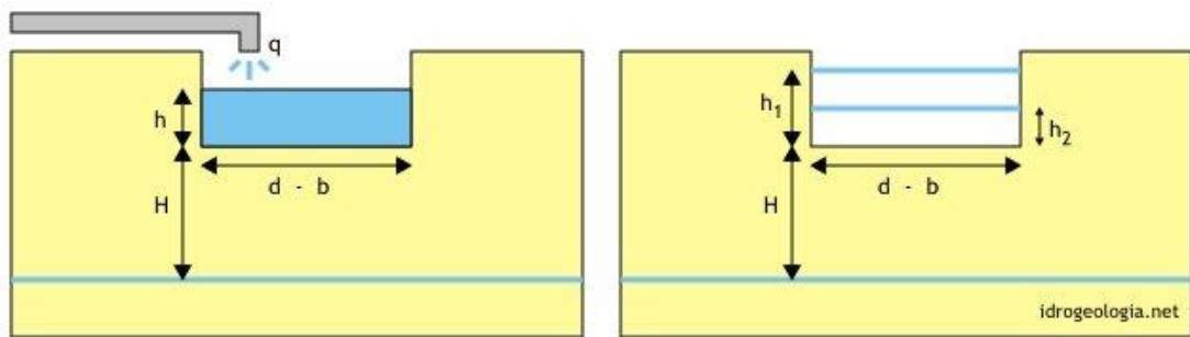
Figura 1. A sinistra: prova di permeabilità in pozzetto a carico costante; a destra: prova di permeabilità in pozzetto a carico variabile (www.idrogeologia.net).
