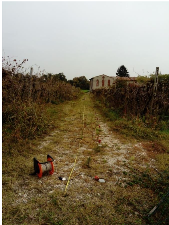
Figura 2. Disposizione dell'indagine MASW.
