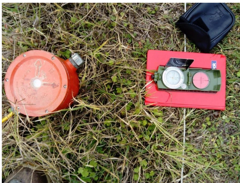
Figura 3. Sismografo EEG con geofono triassiale in fase di acquisizione.
