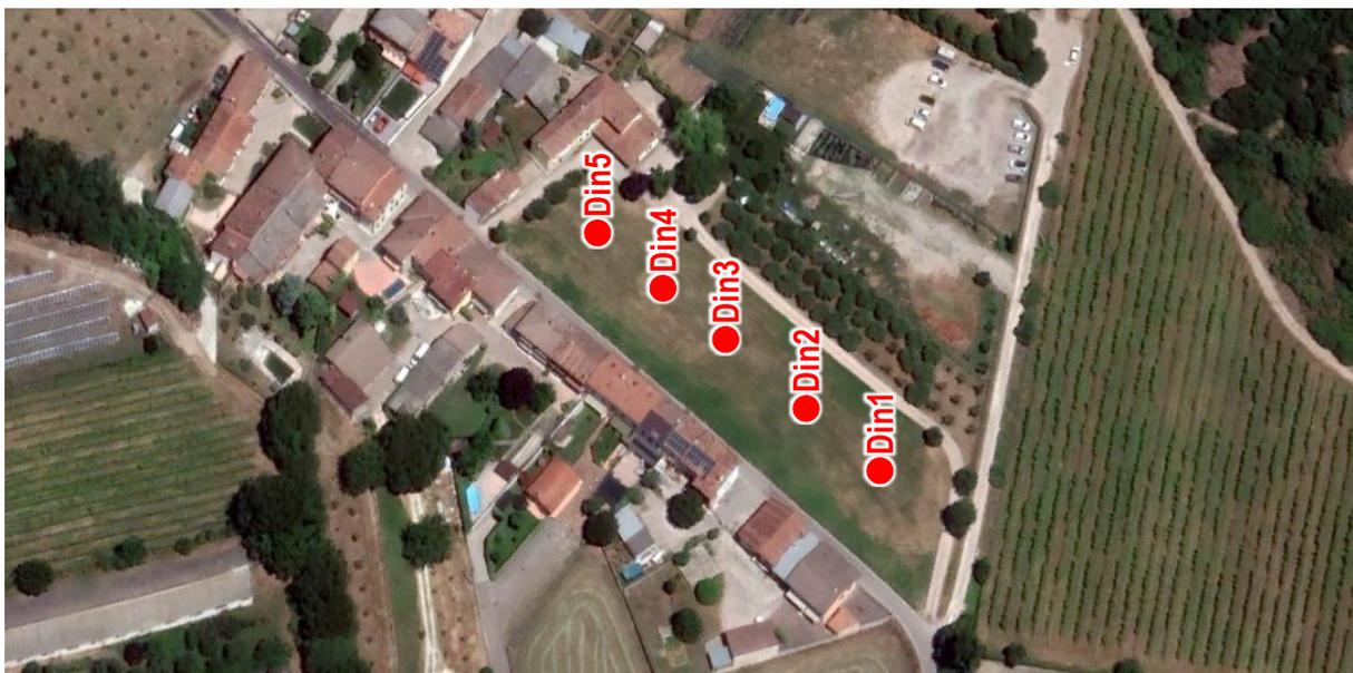
Planimetria con ubicazione e n. prova penetrometrica ●
