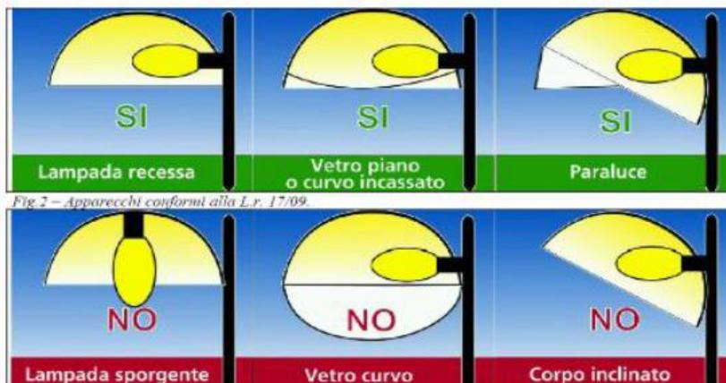
Fig. 2 – Apparecchi conformi alla L.r. 17/09.
